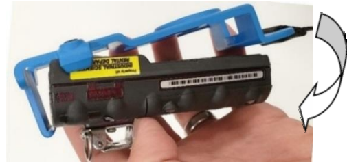
Figura 2 Como acoplar e desacoplar o Standby Clip
